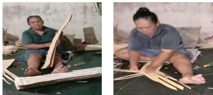
Gambar 1. Proses Pembuatan Anyaman Tikar Bambu
